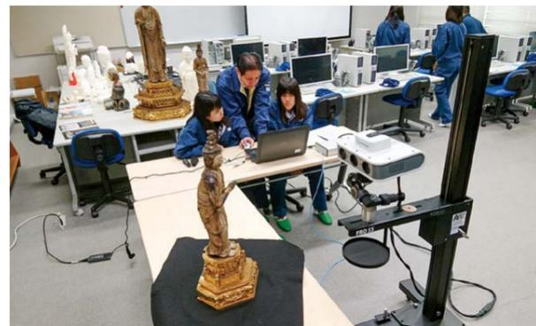
図1 3Dスキャナーによる計測
