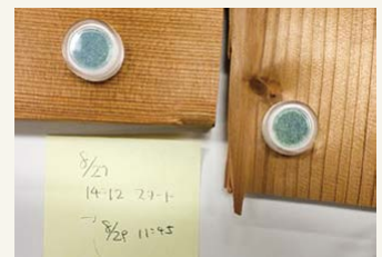
検知剤による、収蔵庫内装木材の有機酸発生状態の検査
